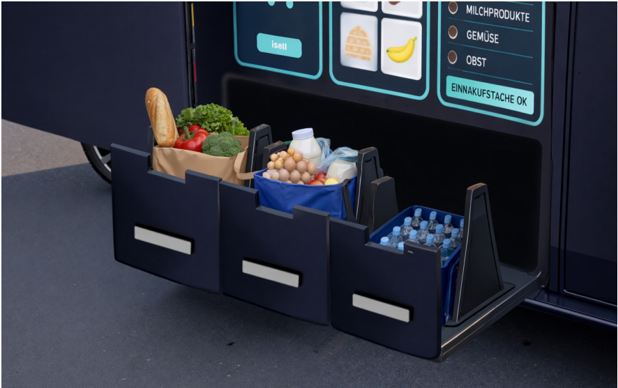
Abb. 24: Ausgefahrene Ausgabeschublade mit befüllten Einkaufstaschen und Wasserkasten; digitale Anzeige signalisiert Entnahmebereitschaft
