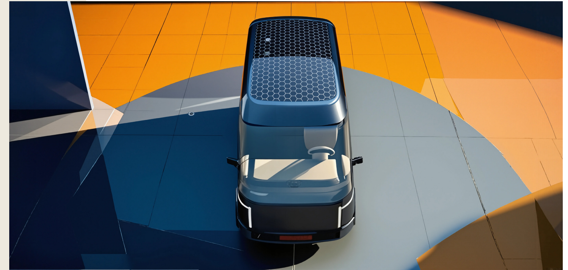
Abb. 39: Flächenbündige integrierte Solaranlage auf der Dachstruktur, Perspektive schräg oben
