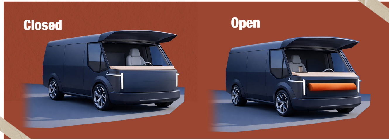
Abb. 29: Technisch-neutral gestaltete Frontpartie mit reduzierter Lichtsignatur und Sitz Mechanismus Idee
